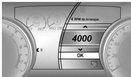
8. Ajuste las RPM deseadas utilizando △ o ▽:
