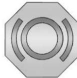
El tapón del depósito del líquido de frenos/embrague hidráulico tiene este símbolo. Vea en *Vista general del compartimiento del motor* ⇨ 260 la ubicación del depósito. El depósito común de líquido del embrague hidráulico y líquido del cilindro maestro de frenos se llena con líquido para frenos como se indica en el tapón del depósito. Consulte *Líquido de frenos* ⇨ 277 respecto al fluido de freno a usar.
