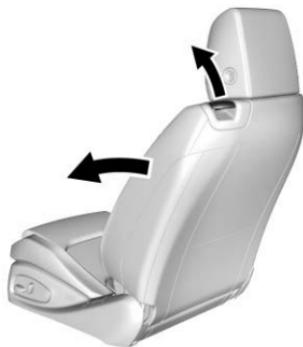
Para tener acceso a los asientos traseros, jale del seguro en la parte superior del respaldo del conductor o del pasajero delantero. Doble el respaldo hacia adelante.
