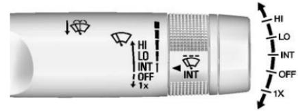
La palanca del limpiaparabrisas/lavador está en el lado derecho de la columna de dirección. Con la ignición encendida o en modo de accesorios, mueva la palanca del limpiaparabrisas para seleccionar la velocidad del limpiador.
