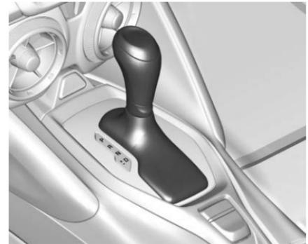
**P** : Esta posición bloquea las ruedas motrices. Utilice P (estacionamiento) al arrancar el motor, ya que el vehículo no puede moverse con facilidad.
