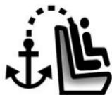
Para ayudar a ubicar los anclajes con correa superior, el símbolo del anclaje de correa superior está ubicado sobre la cubierta del anclaje.
