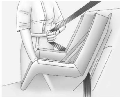
5. Jale el cinturón de hombro completamente fuera del retractor para ajustar el seguro. Cuando el seguro del retractor esté ajustado, el cinturón se puede apretar pero no se puede jalar fuera del retractor.
