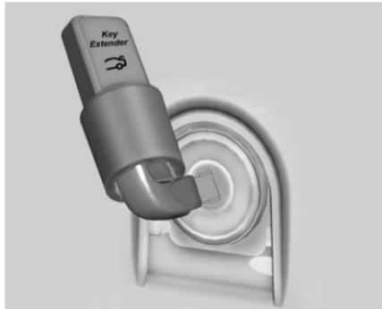
6. Coloque el extensor de la llave sobre la cabeza de la llave hasta que se detenga el extensor de la llave.
