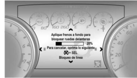
6. Presione el pedal del freno con firmeza para mover el gráfico de barras al 100%.
