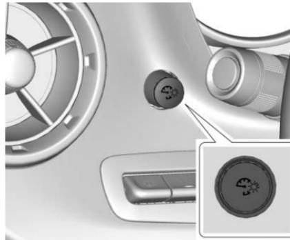
Esta función ajusta el brillo de todos los controles iluminados. El botón para esta función está del lado izquierdo del tablero de instrumentos.
