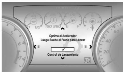
11. Sólo transmisión automática - Aplique rápidamente el acelerador completo. Suelte el pedal del freno para arrancar el vehículo.
