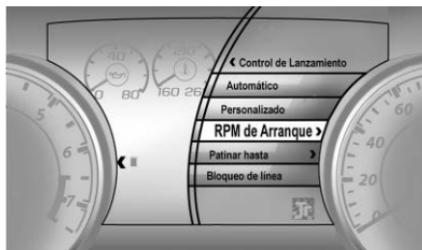
6. Desplácese hacia abajo para lanzar RPM utilizando ▽.
