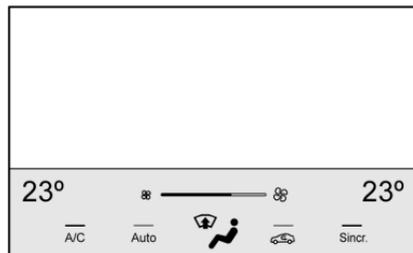
La pantalla de estado de control de clima aparece brevemente cuando se ajustan los controles de clima de la columna central.
