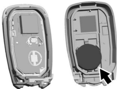
3. Retire la batería empujándola y deslizándola hacia la parte inferior de la llave remota.
