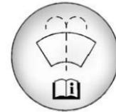
Abra el tapón que tiene el símbolo del lavaparabrisas. Añada líquido de lavado hasta llenar el depósito. Vea en *Vista general del compartimiento del motor* ⇨ 260 la ubicación del depósito.
