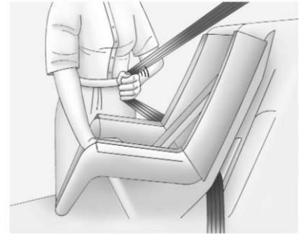
4. Jale el cinturón de hombro completamente fuera del retractor para ajustar el seguro. Cuando el seguro del retractor esté ajustado, el cinturón se puede apretar pero no se puede jalar fuera del retractor.
