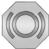
El depósito del cilindro maestro de frenos/embrague se llena con líquido de frenos DOT 4 aprobado por GM, como se indica en el tapón del depósito. Vea en *Vista general del compartimiento del motor* ⇨ 260 la ubicación del depósito.
